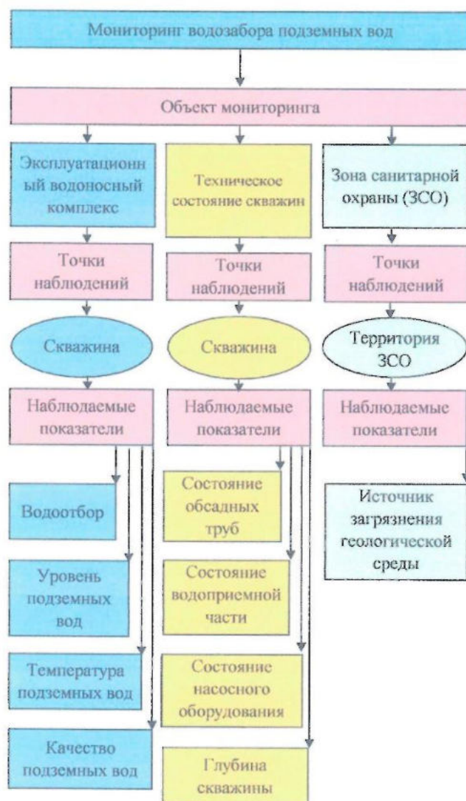
Рис. 4.1 Структура ведения мониторинга на участке водозабора ООО «СКС» (ГОКС)
